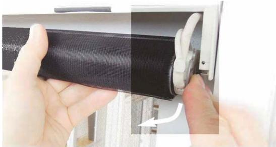
Das Kabel samt Kabelstecker aus dem Motorkopf rausziehen, indem mit einem kleinen Schlitz-Schraubendreher der Klip neben dem Kabel nach innen gedrückt **1** und gleichzeitig am Kabel gezogen wird **2**.
